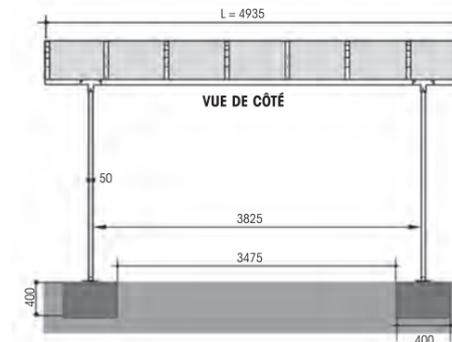
Les carports Ozone®, Singulier® et Pluriel® sont à cheviller dans des plots bétons de 400x400x400 ou dans une chape.
