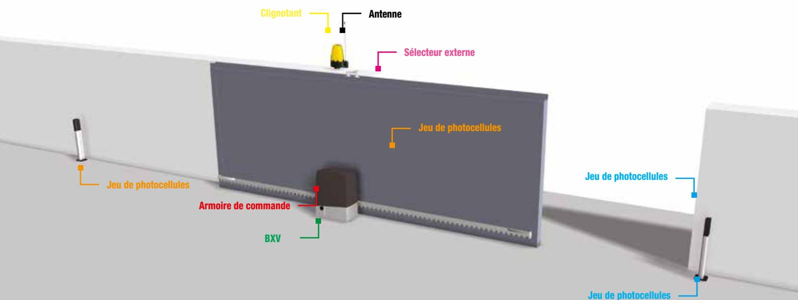
Typologie de câblage - ● 230 V AC ● 2 x 0,5 mm<sup>2</sup> ● 4 x 0,5 mm<sup>2</sup> ● 3 x 1,5 mm<sup>2</sup> ● 3 x 0,5 mm<sup>2</sup> ● 2 x 1 mm<sup>2</sup> ● RG58
