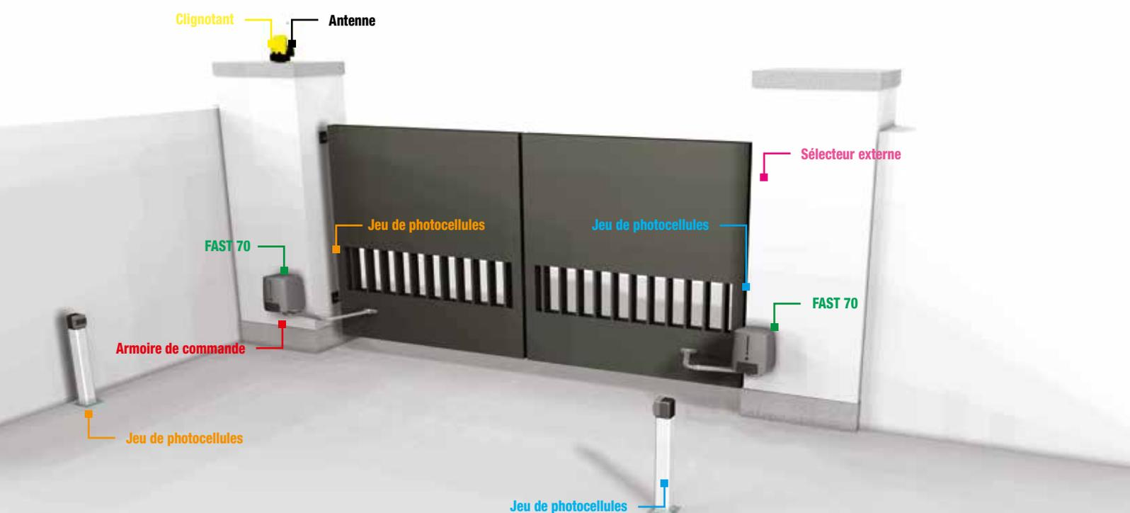
Typologie de câblage - ● 230 VAC ● 2 x 0,5 mm<sup>2</sup> ● 4 x 0,5 mm<sup>2</sup> ● 3 x 1,5 mm<sup>2</sup> ● 3 x 0,5 mm<sup>2</sup> ● 2 x 1 mm<sup>2</sup> ● RG58
